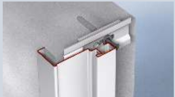
Eckzargen-Profil 1 mit dem Ständerwerk verschrauben
